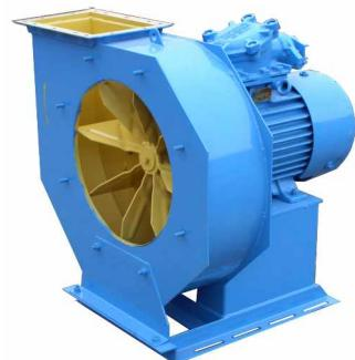
Вентиляторы ВРП изготавливаются по 1-ой схеме исполнения (колесо расположено на валу электродвигателя) и по 5-схеме исполнения (клиновременная передача). По спецзаказу вентиляторы ВРП могут быть изготовлены по 3-ей схеме исполнения (через узел вала и муфту)
