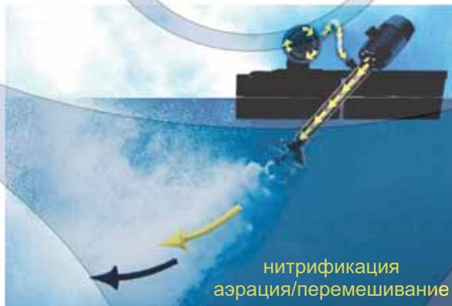
рис.2 - Process Aerator работает в режиме Аэрации+перемешивания
