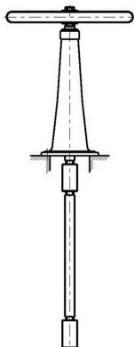
Опора с электроприводом и шпиндельным валом
