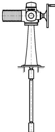
Шпиндельный вал с ручным маховиком
