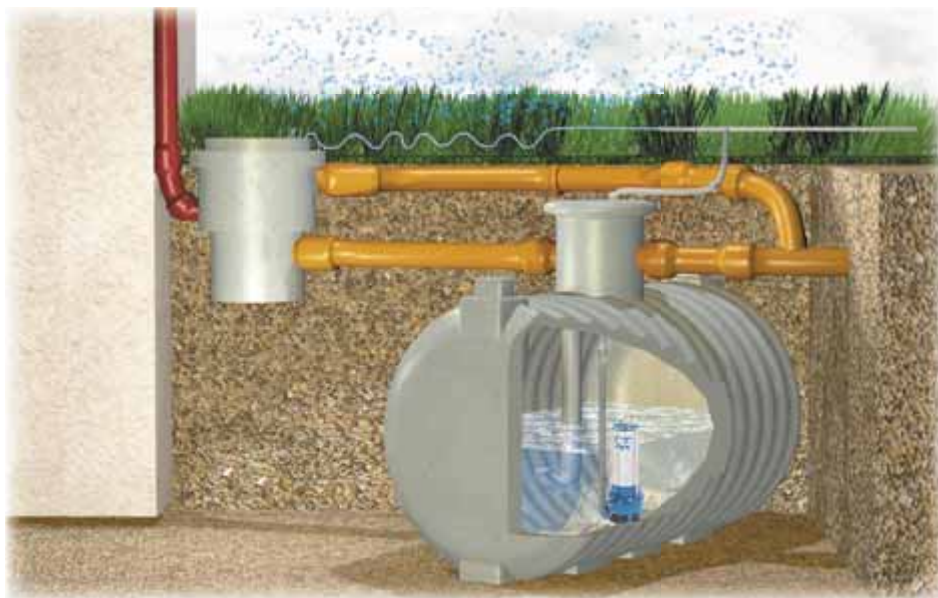
Комплект оборудования для применения дождевой воды в огороде
